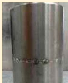
Tuyau de soudure (bout à bout) Ø 31,75 x 2 mm.
